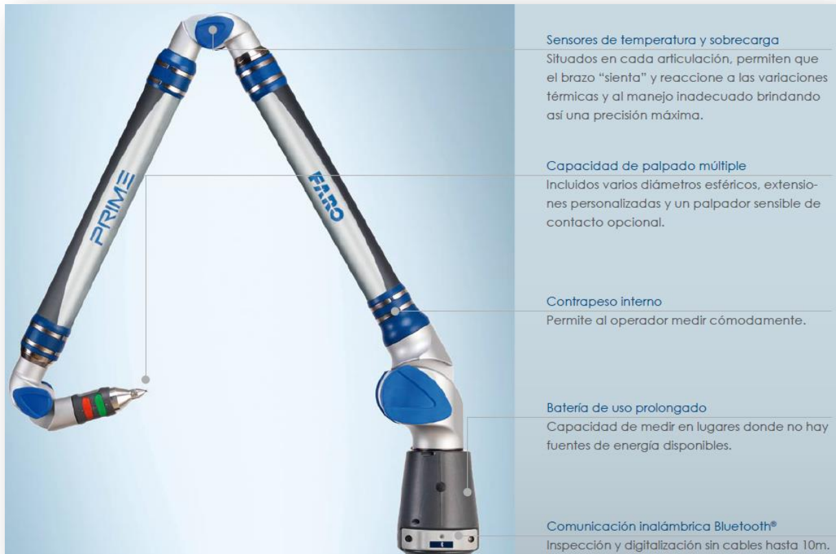
Figura 3.5. Componentes del Faro PRIME.
