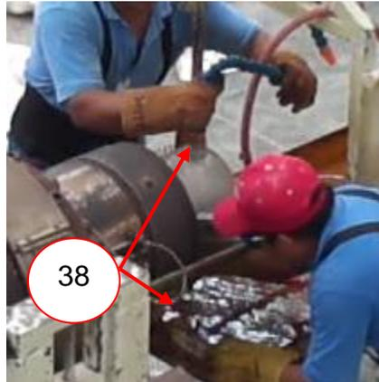
**Figura 5.30** Colocar mangueras a formador
