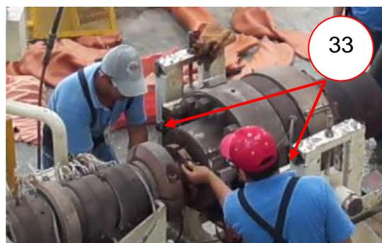
**Figura 5.27** Atornillar cabezal a extrusora
