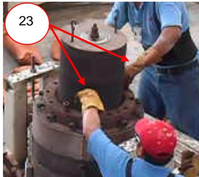
**Figura 5.22** Colocar tornillos al anillo del dado
