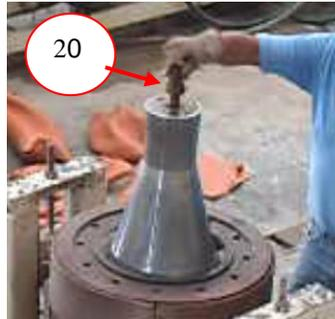
**Figura 5.19** Colocar y apretar el tornillo que sujeta al cono
