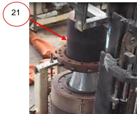
**Figura 5.20** Colocar dado a cabezal
