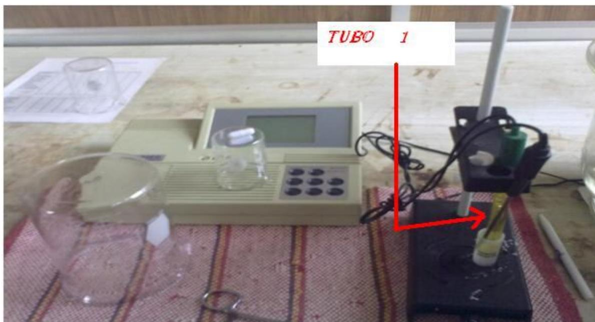
Fig. 33.- Medidor de pH.
