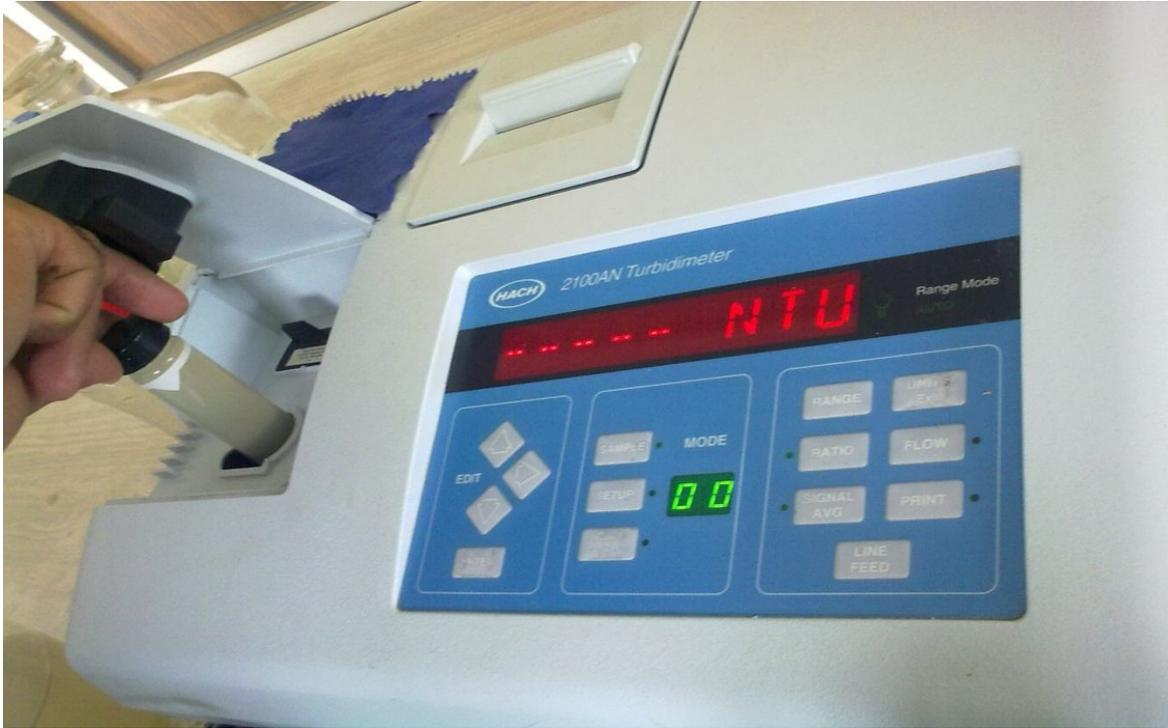
Fig. 34.- Turbidímetro.
