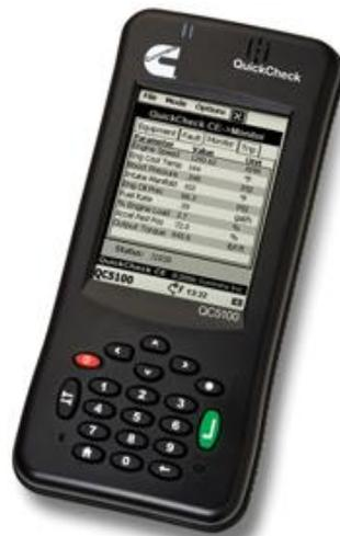
**Figura 4.4.** Quickcheck (Escáner para medir parámetros de la unidad).
