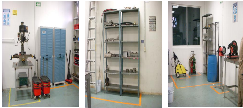
Figura 4.38 Delimitación de Áreas del Taller Mecánico Industrial
