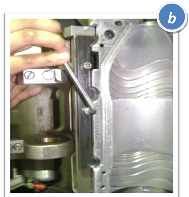
Desatornillar con allen 5 mm, dos tornillos de cada cuerpo de molde.
