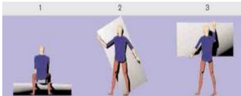
Figura 5.8. Sistema de levantamiento con tres puntos de apoyo.
