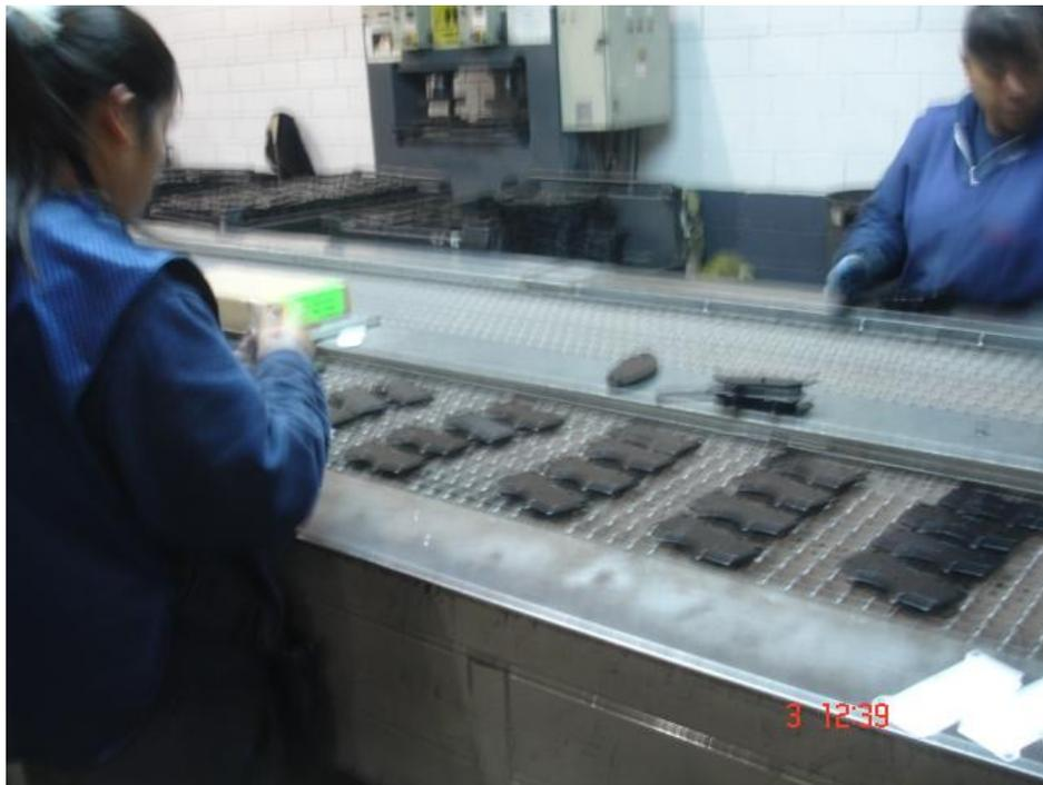
**Figura 2.21** Aplicación de Laminas Anti-ruido
