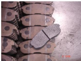
**Figura 2.16** Pastilla mecanizada
