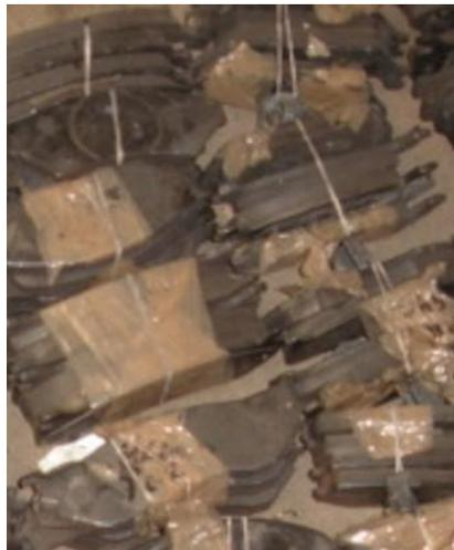
**Figura 7.10** Pastillas de Freno Oxidadas
