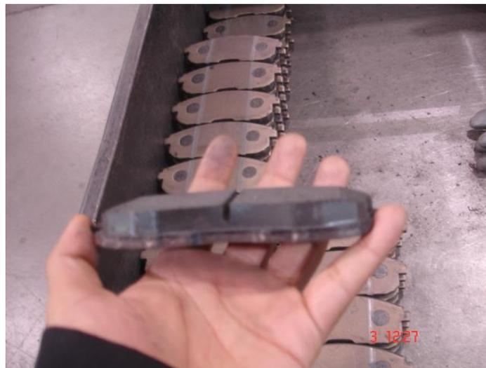
**Figura 2.15** Pastilla después de pasar por Mecanizado (Ranura y Chaflán)
