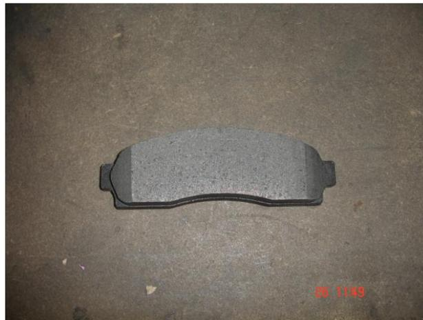
**Figura 3.2** Pastilla Metálica C.18
