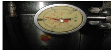
9.-En el esterilizador verificar la presión de envasado que este en 1 bar.
