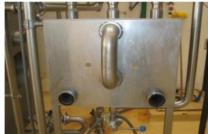
12- se dirige hacia el 1º manifiù (donde se controla el flujo del tanque de 1000 litros, de 8000 y el de la línea de producción) y se coloca la tubería en línea de producción.
