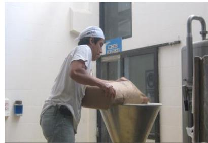
6.- Las sustancias ligosas es necesario calentar un poco de leche hasta que hierva con ayuda del tanque de 200 litros y con la manguera de vapor. Y se procede a introducir las sustancias.
