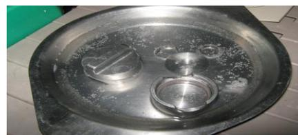
13.- se desarman los dos cilindros de dosificación se revisan que estén limpias y se lubrican los o`ring con grasa alimenticia.
