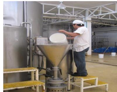
8.- Una ves terminada la preparación, se abren y se cierran las válvulas correspondientes para hacer circular la leche del tanque de 1000 al de 8000 litros.
