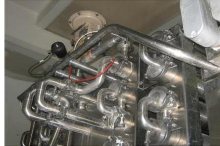
15.- En el esterilizador se revisan los codos del tubo de sostenimiento, el filtro del producto, las ollas de producto y agua.
