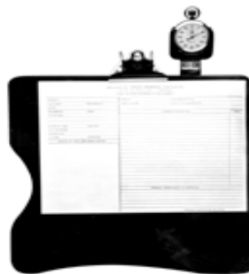
Figura 3.2 Tablero de observación con cronometro
