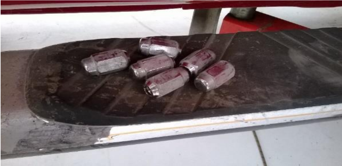
Figura 6.12. Ubicación provisional de birlos, que causa movimientos innecesarios, desorganizados.
