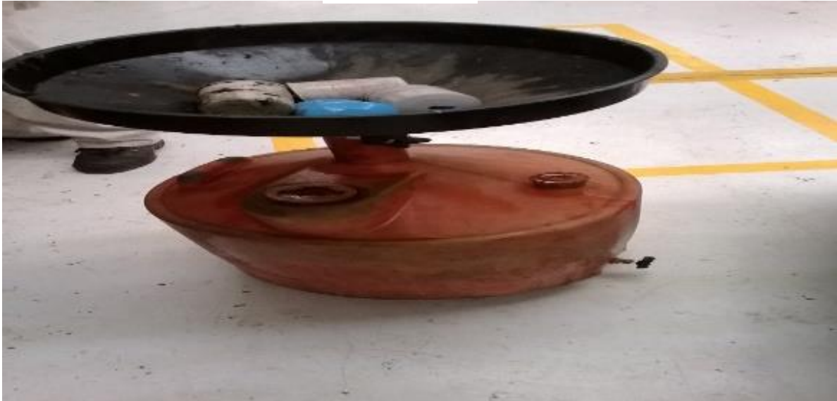
Figura 6.14. Contenedor con falla en la fuente de salida.
