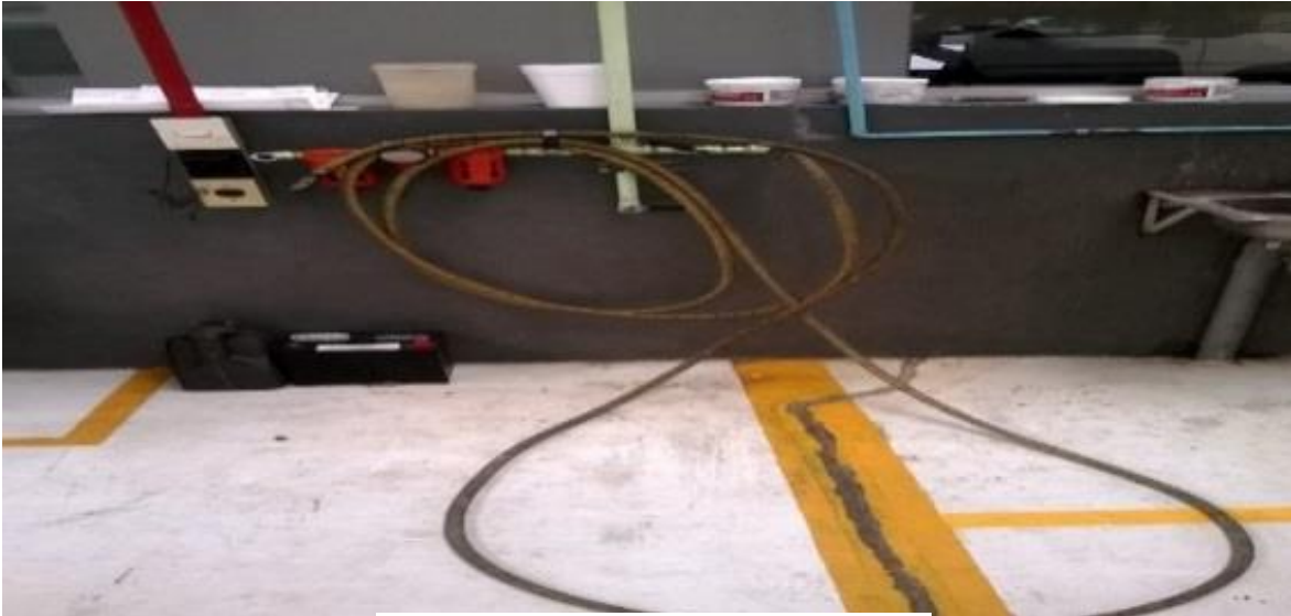
Figura 6.16. Ubicación óptima y cambio de diseño de manguera para mejor manejo.
