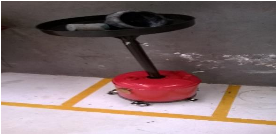
Figura 6.15. Contenedor con diseño de fácil Vaciado y derrame mínimo.
