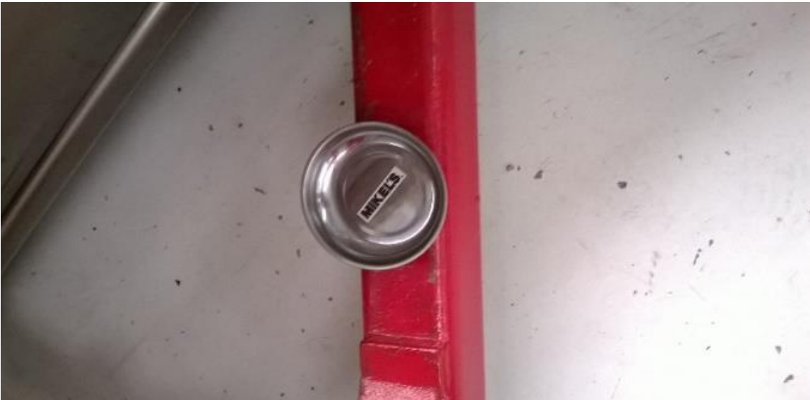
Figura 6.13. Charola magnética que permite fácil acceso a los birlos y menos movimientos innecesarios.
