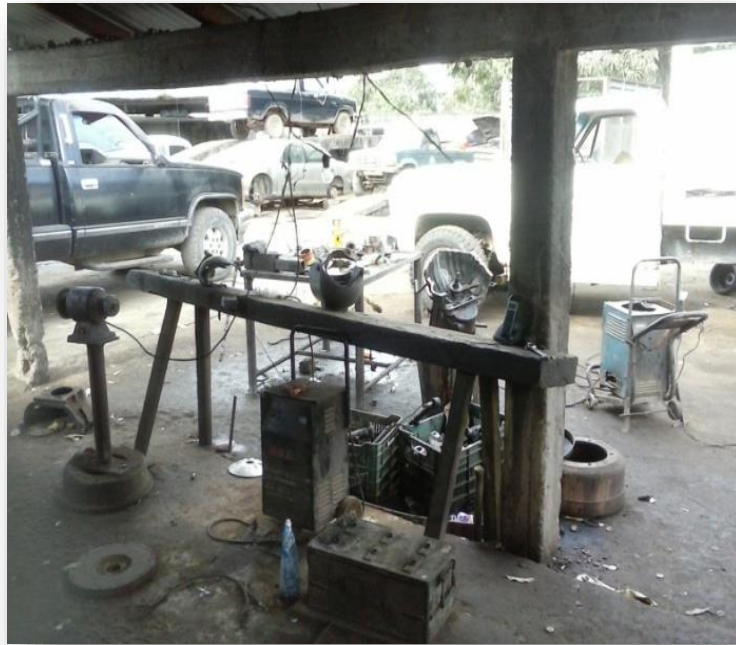
Figura 4.5 Cables de corriente en mala ubicación
