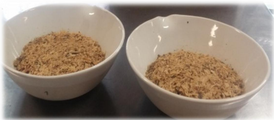
Figura 4 Los 20 gr de cisco en el crisol
