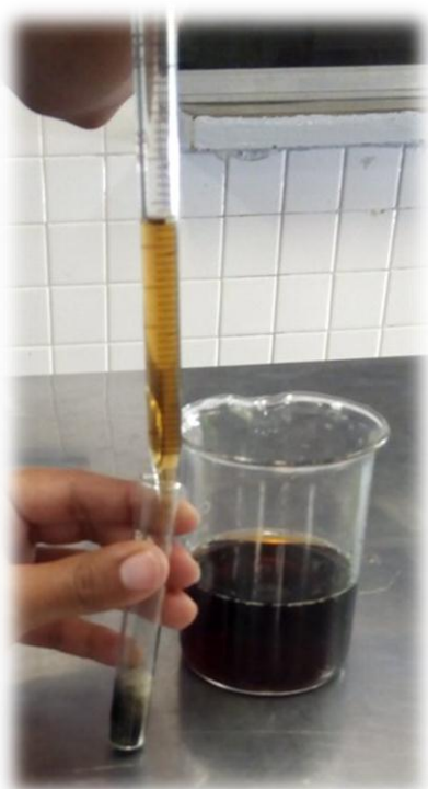
Figura 12 Probeta con 5 ml de refresco de cola vaciándolo a tubo de ensayo que contiene carbón activado.
