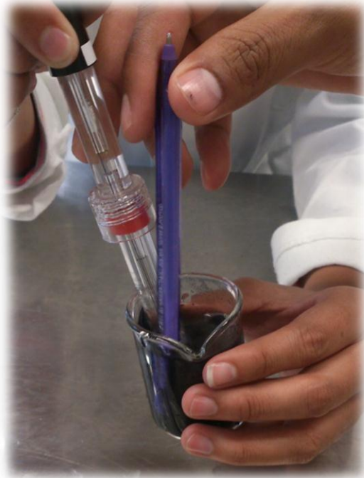
Figura 17 Agitación constante de la muestra en la prueba de PH.
