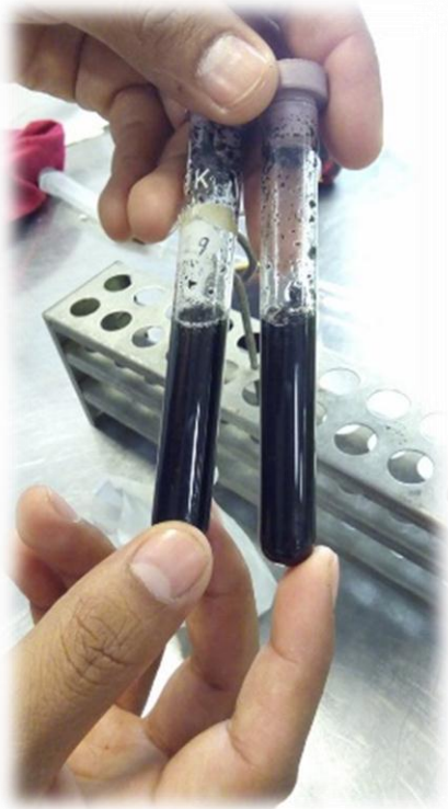
Figura 13 Tubos de ensayo en la prueba de adsorción de refresco de cola.
