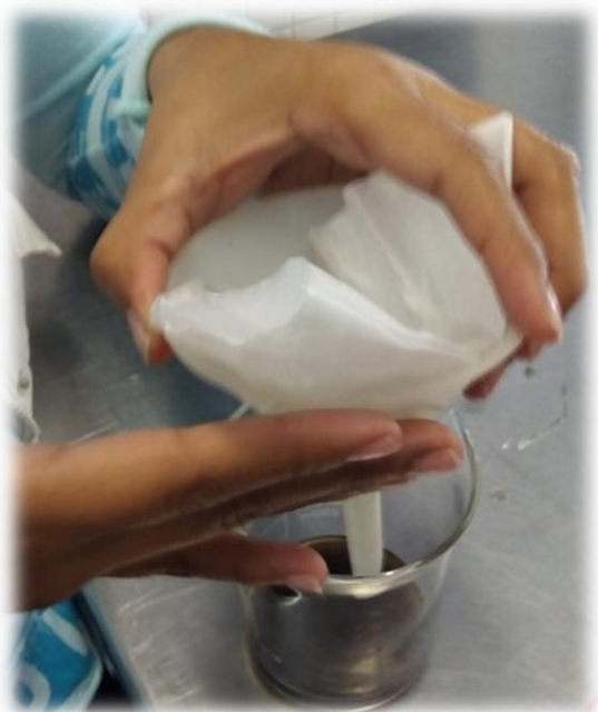
Figura 15 Con ayuda de un papel filtro se coló el carbón en la prueba de adsorción.
