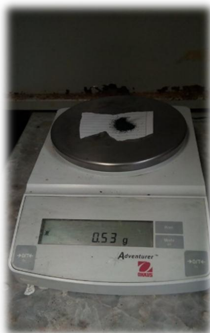
Figura 10 Balanza pesando 0.50 gr de carbón activado para llevar a cabo la prueba de adsorción.
