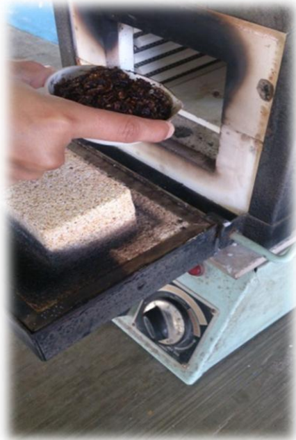
Figura 5 Mufla utilizada en la carbonización
