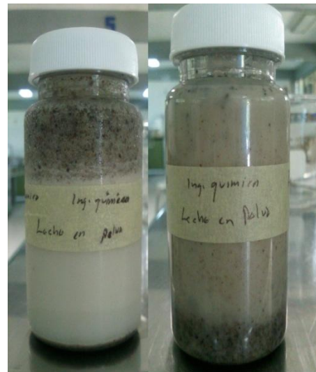
PRODUCTO CON LECHE EN POLVO CON Y SIN REFRIGERACIÓN.
