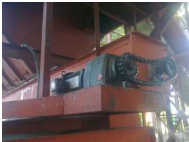
Figura 6.10 Engrasado de la cadena en el área de desfrutador
