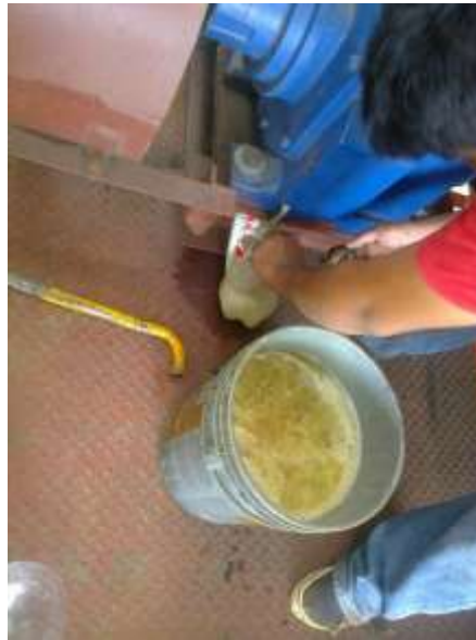
Figura 6.9 Cambio de aceite a uno de los motores en el área de desfrutador (Fuente: Recopilación propia)
