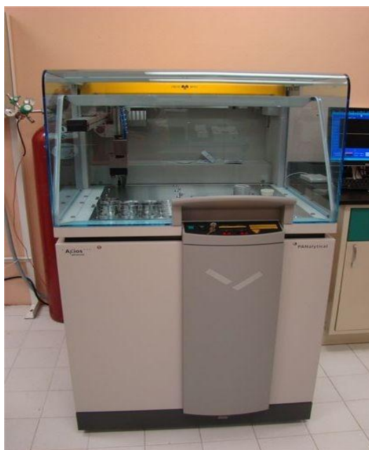
Figura 8 – Imagen del equipo de FRX-WDXRF utilizado en la validación.
