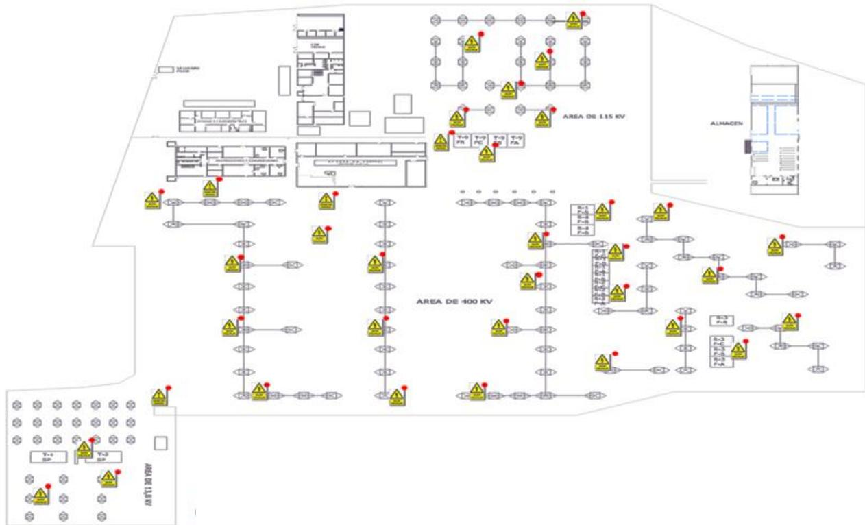
**Fig. 5.14.8** Plano de distribución con señalamientos de Precaución del Área de 400 Kv., 115 Kv. Y 13.8 Kv. de la Subestación Manuel Moreno Torres
