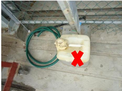
**Imagen 5.5.3.2** Contenedor de gasolina sin señalización, taller eléctrico
