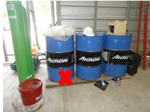
**Imagen. 5.5.3.1** Sustancia química sin señalización, en taller eléctrico
