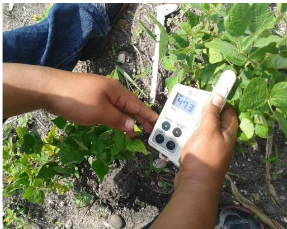
Figura 13: Determinación de clorofila con un medidor de clorofila SPAD-502 Plus fabricado por la compañía konica minolta en el año 2009.
