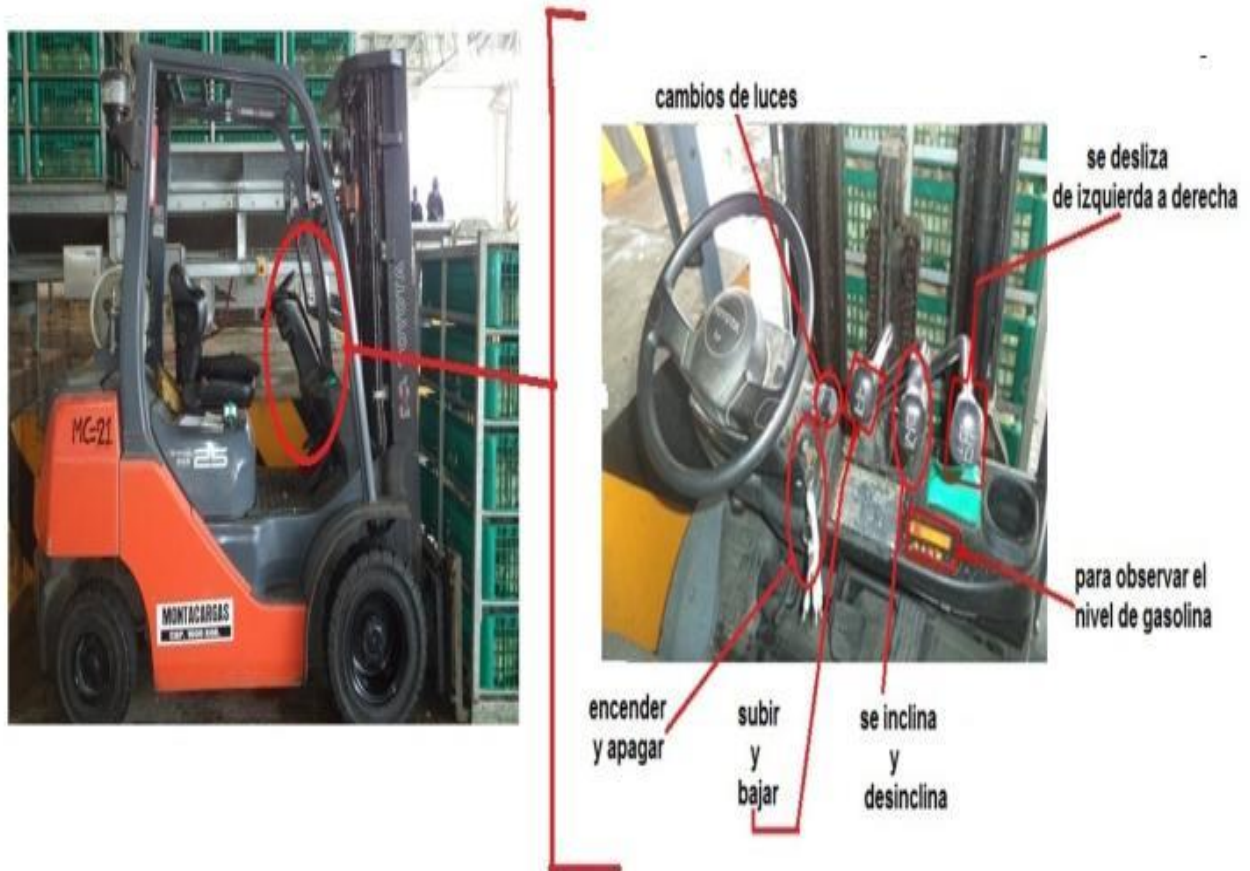
Figura 5.3. (Partes exteriores del montacargas).
