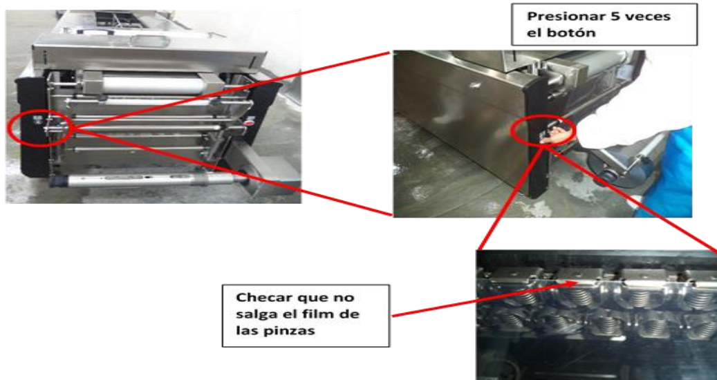
Figura 18. Prender la maquina manualmente para asegurarse que no salga el film de las pinzas
