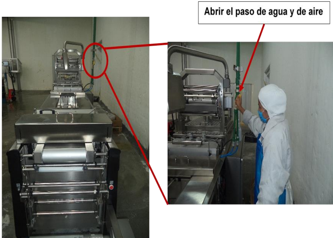
Figura 2. Paso de agua y aire.
