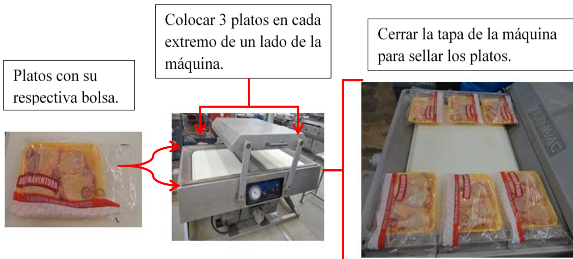
Figura 4.- Colocación de los platos para sellarlos.
