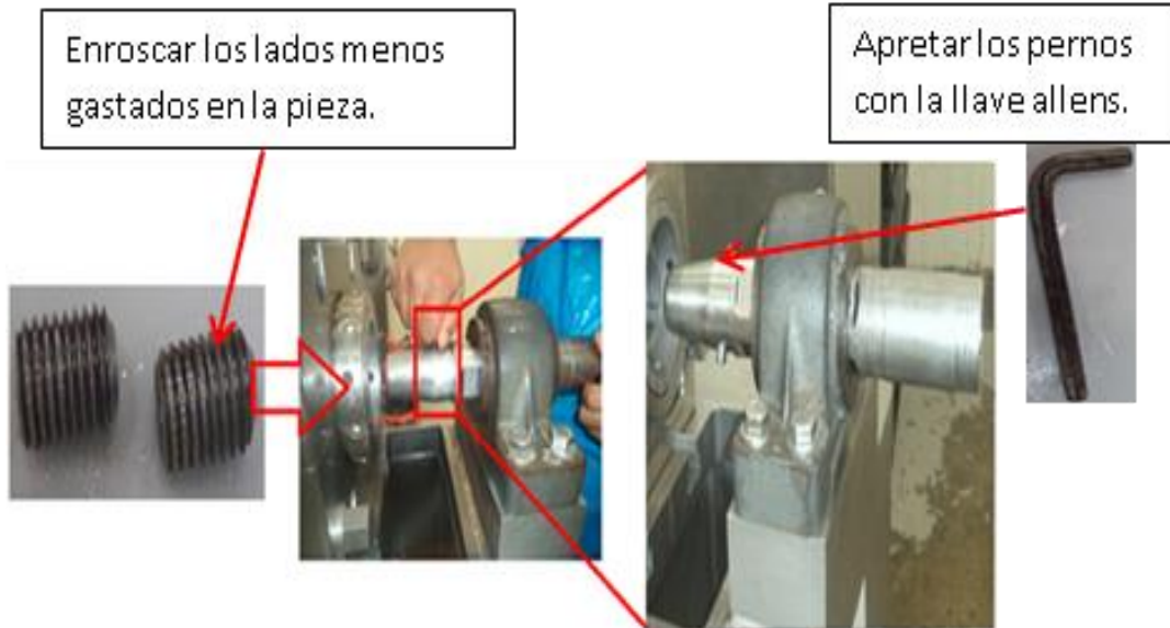
Figura 24.- Colocación de los pernos.
