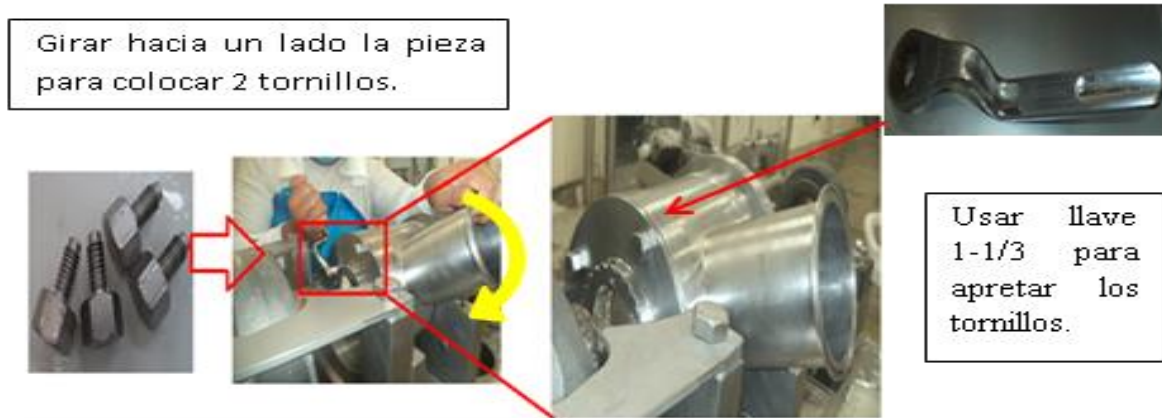
Figura 8.- Colocación de 2 tornillos.
