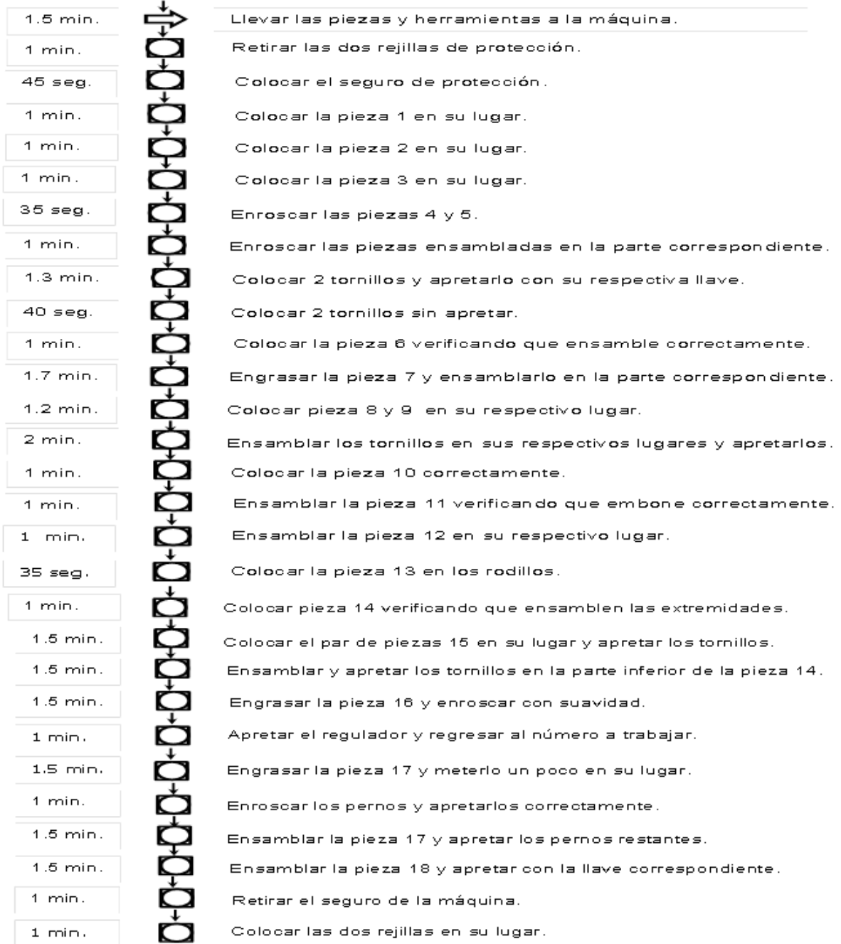
Diagrama de flujo del armado de la separadora EMI
