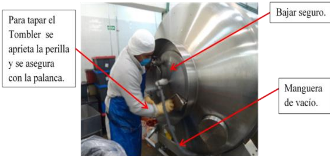
Figura 3.- Colocación de la tapa y manguera de vacío.
