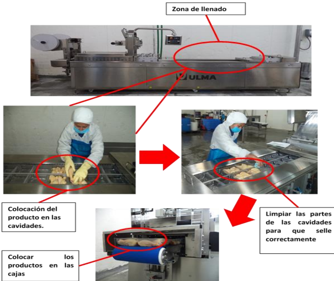
Figura 20. Colocación del producto en las cavidades.
