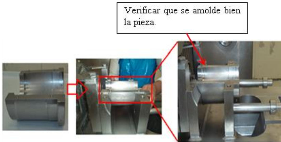
Figura 3.- Colocación de la pieza 1
