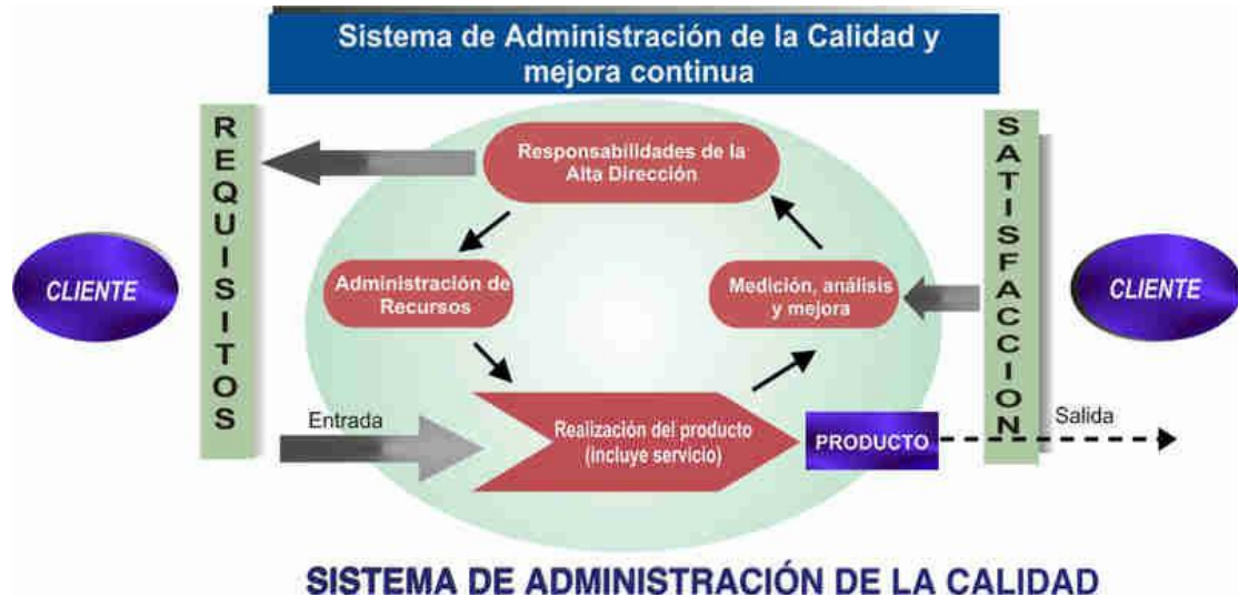
Figura 3. 1: Basado en procesos cuando se desarrolla, implementa y mejora la eficacia de un Sistema de Gestión de calidad.
