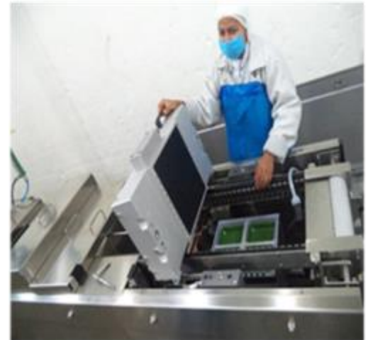
Figura 6. Desenroscar el conector y levantar suavemente la horma de formado.
