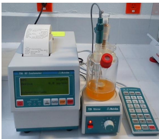
Figura 10.1a) Karl Fischer modelo 756 coulometer, 782 stirrer. b) Stabinger Viscometer modelo SVM300 marca AntonPaar.
