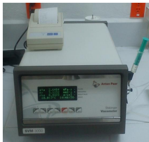
Figura 10.1a) Karl Fischer modelo 756 coulometer, 782 stirrer. b) Stabinger Viscometer modelo SVM300 marca AntonPaar.
