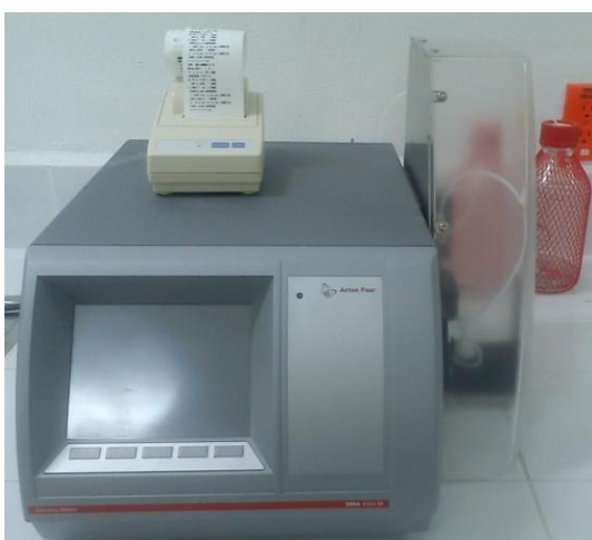
Figura 10.2a) Density Meter modelo DMA 4500M marca AntonPaar. b) Rancimat modelo 743 marca Metrohm.
