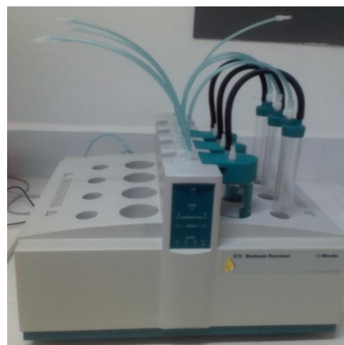
Figura 10.2a) Density Meter modelo DMA 4500M marca AntonPaar. b) Rancimat modelo 743 marca Metrohm.
