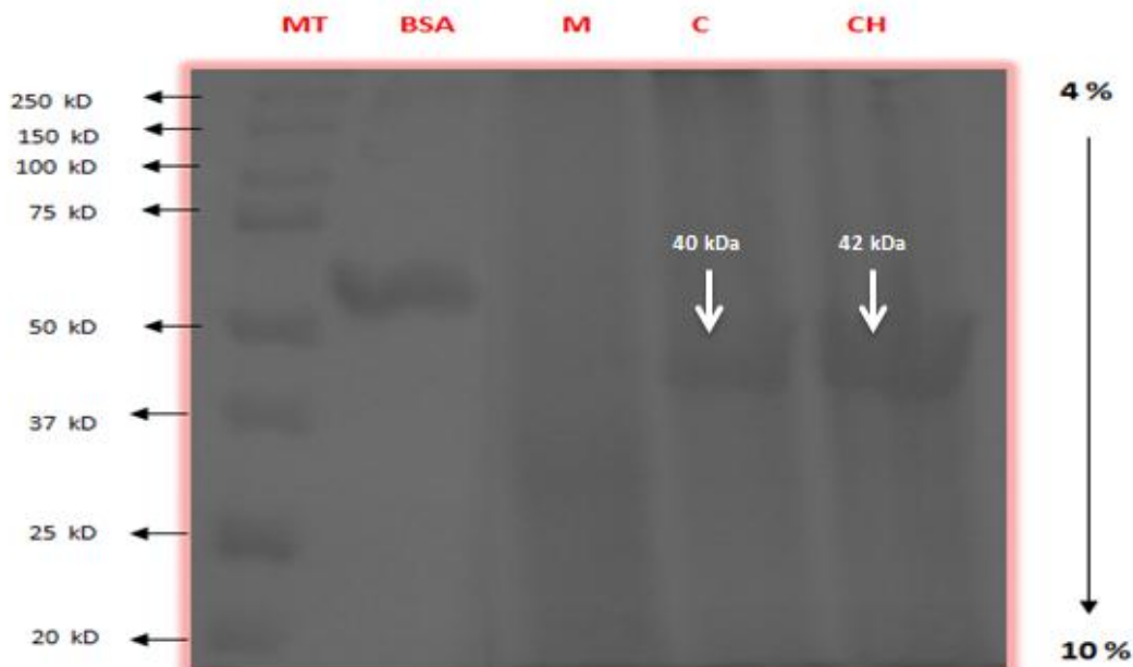
Figura 23. Gel de poliacrilamida en gradiente del 4% al 10% por el método TCA; en el que se muestra los pesos moleculares de Marcador de Tamaño (MT); albúmina de suero bovino (BSA); Moringa (M); Canavalia (C) y Crotalaria (CH)
