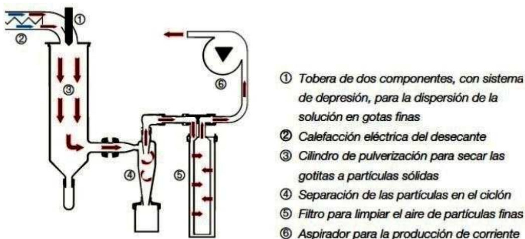
Figura 6. Esquema de equipo de secado por aspersión
