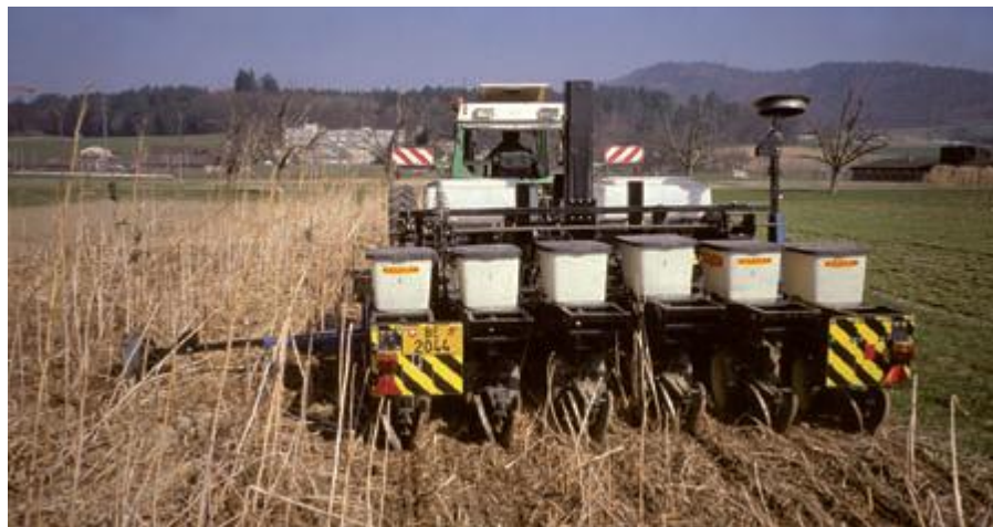
Figura 7. Sembradora directa con equipamiento de laboreo cero en funcionamiento sobre rastrojo.
