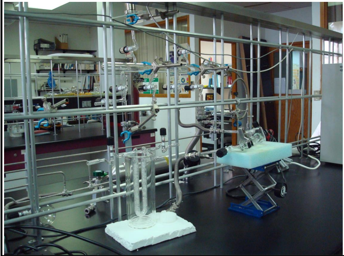
Figura 19. Manifold, reactor, trampa fría y equipos utilizados en las simulaciones del laboratorio de atmósferas planetarias.
