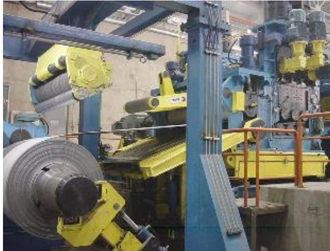
Imagen 7. Rollo pasando por la mesa de corte Fagor.
