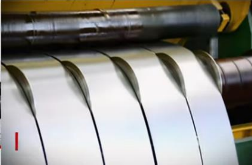
Imagen 9. Tiras de material cortado, enrollándose.
