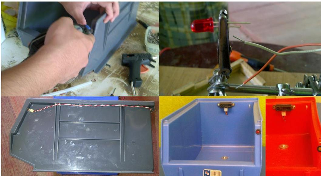
*Figura No. 4.16. Instalación de los leds en los contenedores*
