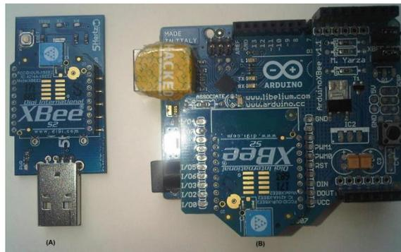
Figura 4.13 Par de Transmisores/Receptores XBee
