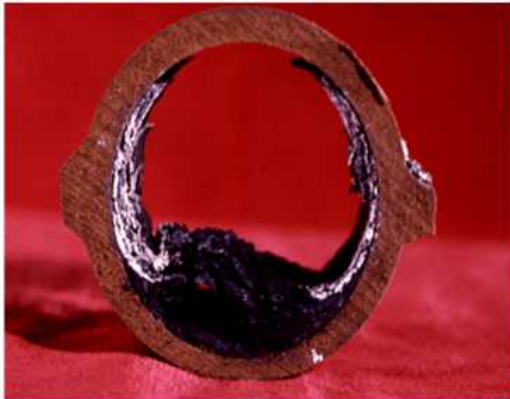
FIGURA 2.- INCRUSTACIONES POR DUREZA
