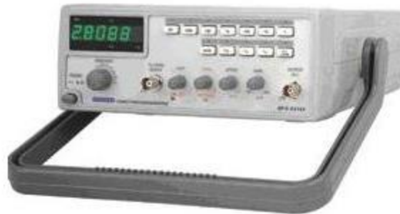
Figura 5.10 Generador de Señales
