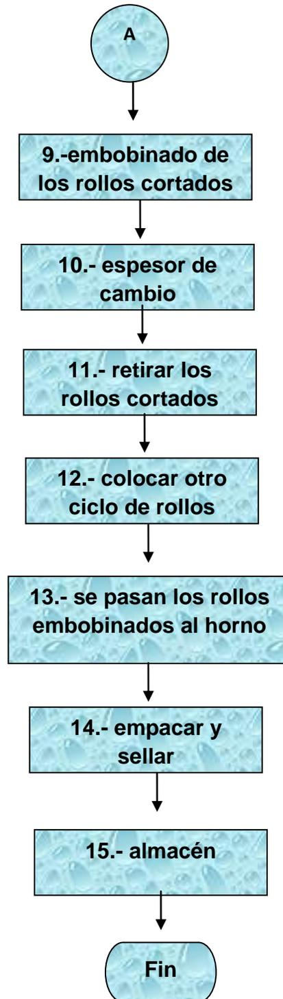
Figura 5.4 Diagrama de flujo para máquinas de Mamut
