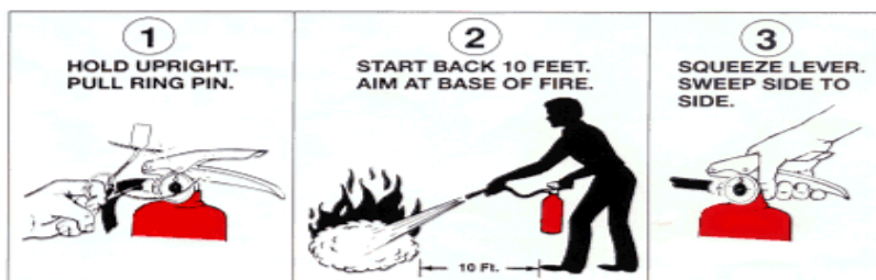
Figura 5.1 uso de extintores
