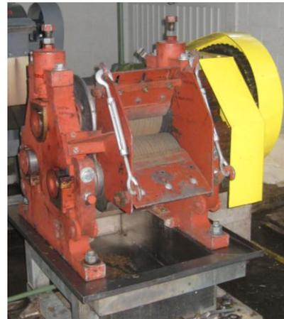
**Figura 7.8** Molino de rodillos
