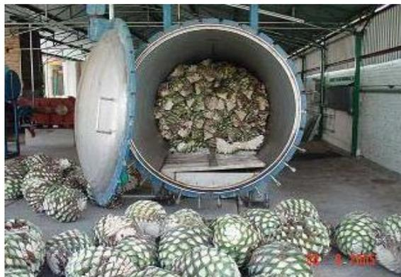
**Figura 7.6** Cocción de piñas en autoclave
