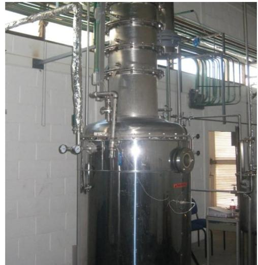
**Fig. 7.13** Destilador de columna de platos
