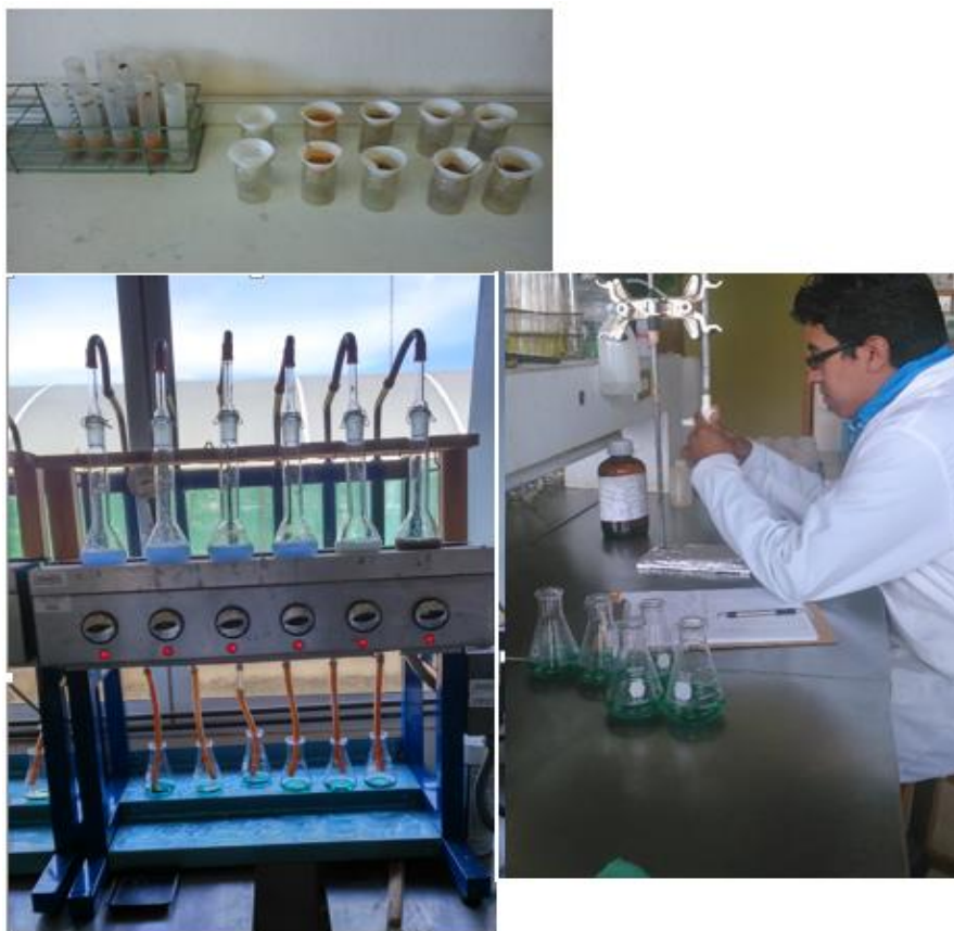
Figura 20. Muestras filtrándose, destilador micro-kjeldhal y autor titulando por medio de una bureta.
