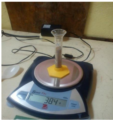
Figura 16. Balanza semi-analitica con Probeta 10 ml para determinar densidad aparente en el suelo.
