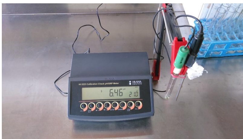
Figura 18. Potenciómetro marca Hanna para determinar pH.
