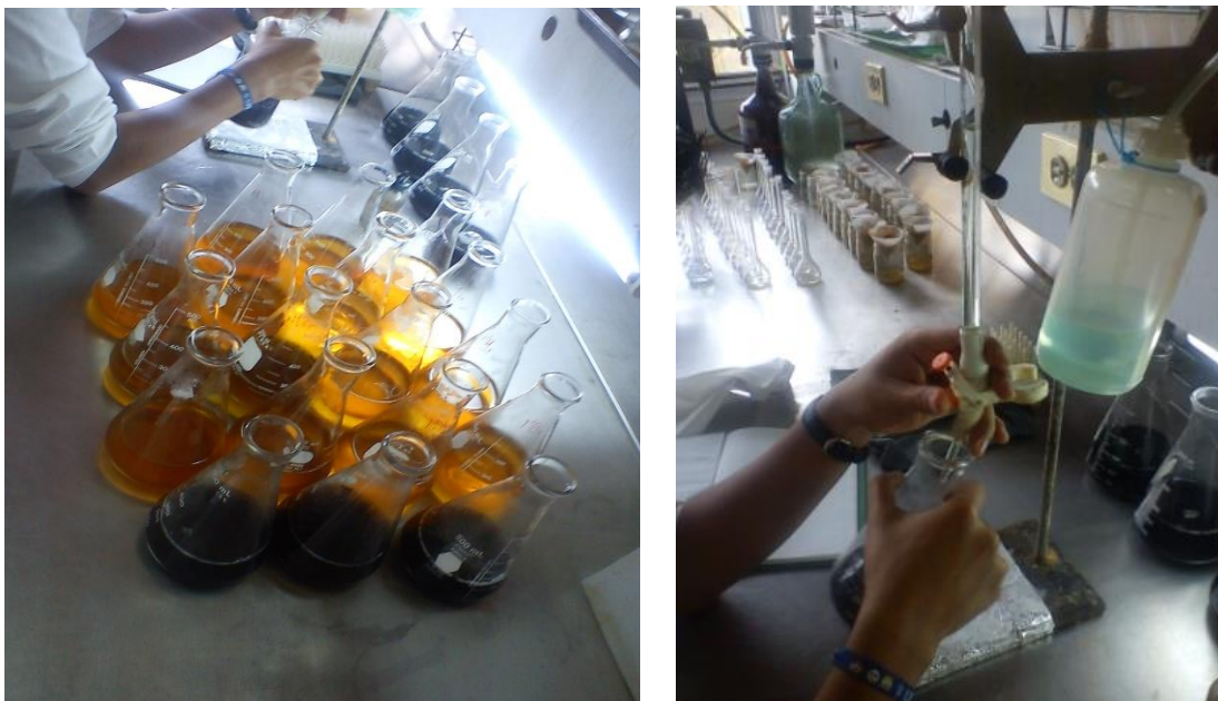
Figura 21. Matraces Erlenmeyer 250 ml con muestra y bureta con el reactivo titulante para materia orgánica.
