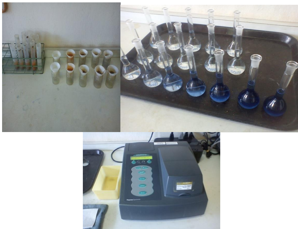
Figura 22. Muestras de suelo filtrándose, Matraces aforados 50 ml (muestra y curva de calibración) y Espectrofotómetro GENESYS.
