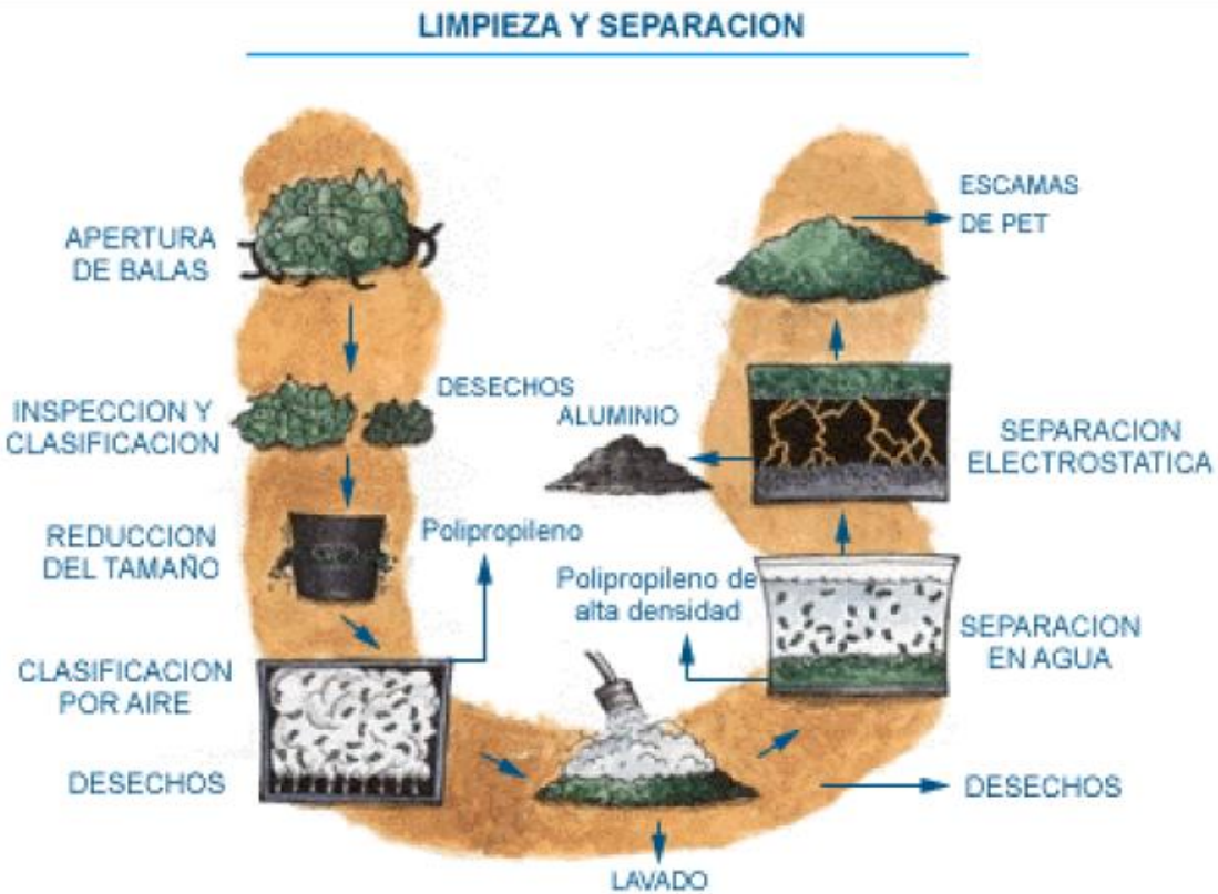
Figura 5. Reciclado mecánico con mezcla de materiales. [6]
