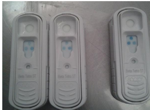
Figura No. 2 Equipo para determinar antibióticos en leche.
