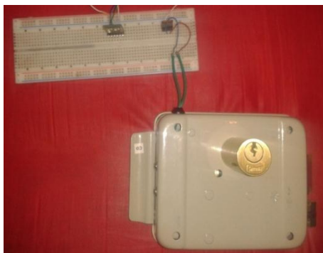
Figura 4.2.- Conexión de la chapa en la protoboard
