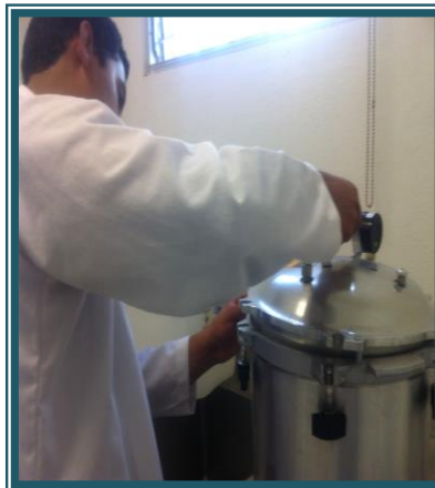
Una vez colocados en la autoclave son sometidos a una temperatura de 121 ° C durante 15 minutos
